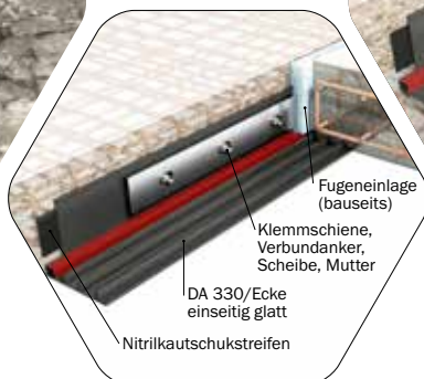
KRASOflex® Klemmkonstruktion - außenliegend Außenliegendes Dehnungsfugenband DA 330/35 nach DIN 18541 Neues Bauteil an bestehendes Bauteil
