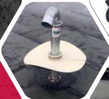
UV-bescherming met omlopende, druiprand aan de onderzijde, verdraai-beveiliging, KRASO® Folieklemsflens Type FKF
