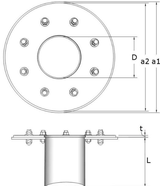
• D | Futterrohr Innendurchmesser (mm) • a1 | Außendurchmesser Festflansch (mm) • a2 | Außendurchmesser Losflansch (mm)
