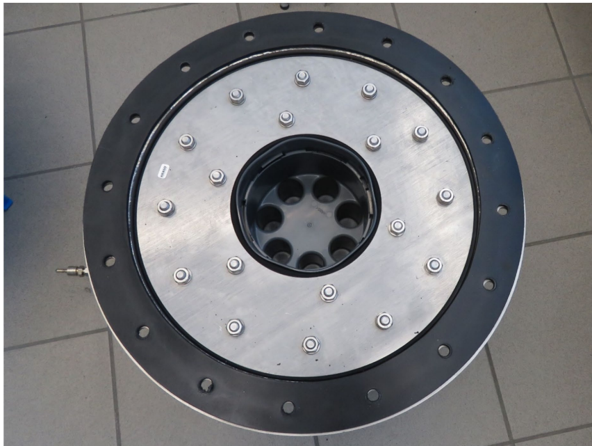
Abbildung 4: Prüfaufbau mit Dichteinsatz Typ SD verspannt, Innenansicht nach Versuchsdurchführung
