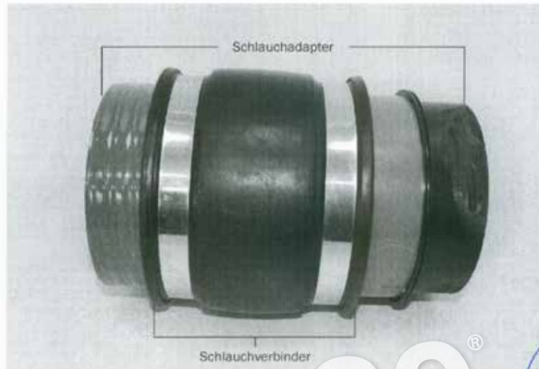
Bild 1: Prüfgegenstand: Schlauchadapter mit Schlauchverbinder
