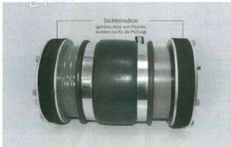
Bild 2: Schlauchadapter und Schlauchverbinder im Einbauzustand mit Dichteinsätzen
