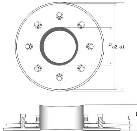
• D | Futterrohr Innendurchmesser (mm) • a1 | Außendurchmesser Festflansch (mm) • a2 | Außendurchmesser Losflansch (mm)
