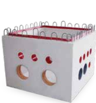
KRASO® Pumpensumpf - Beton - Sonder Innenmaße ca. 100 x 100 x 80 cm, aus WU-Beton, mit 12 cm starken, stahlfaserbewehrten Wänden aus einem Guss. Anschlussbewehrung ca. 8/15 doppelreihig, umlaufendes, druckwasserdichtes, MPA-geprüftes, Arbeitsfugenband KRASOflex® Duo-Fix 150 „plus“, 4 Transportanker M20, Anschlüsse: 8 x DN 110, 2 x DN 250, 2 x ID/FE 200, Gesamtgewicht: ca. 1,5 t
