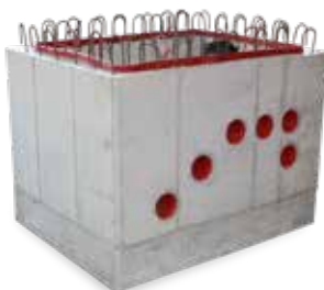
KRASO® Pumpensumpf - Beton - Sonder Innenmaße ca. 100 x 70 x 80 cm, aus WU-Beton, mit 20 cm starker, stahlfaserbewehrter Wand- und Bodenplatte (20 kg/ per cbm). Anschlussbewehrung ca. 8/15 doppelreihig, umlaufendes, druckwasserdichtes, MPA-geprüftes, Arbeitsfugenband KRASOflex® Duo-Fix 150 „plus“, 4 Transportanker M20, Anschlüsse: 6 x DN 125, Gesamtgewicht: ca. 2,4 t
