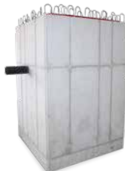
KRASO® Pumpensumpf - Beton - Sonder Innenmaße ca. 104 x 104 x 192 cm, aus WU-Beton, mit 20 cm starker, stahlfaserbewehrter Wand- und Bodenplatte (20 kg/ per cbm). Anschlussbewehrung ca. 8/15 doppelreihig, umlaufendes, druckwasserdichtes, MPA-geprüftes, Arbeitsfugenband KRASOflex® Duo-Fix 150 „plus“, einschließlich PE Rohr DN 124 mit umlaufender, druckwasserdichteter KRASO® Vierstegdichtung mit beidseitigem Überstand von ca. 15 cm, 4 Transportanker Rd20, Gesamtgewicht: ca. 5,94 t
