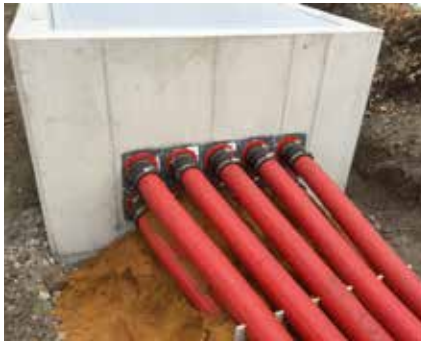
KRASO® Zug- und Kabelschacht - Sonder Innenmaße ca. 140 x 140 x 110 cm, inkl. Winkelrahmen-einbau, aus WU-Beton, mit 20 cm starken, stahlfaserbewehrten Wand- und Bodenplatten ( 20 kg/ per cbm ), ohne Anschlussbewehrung/Fugenband, 10 KRASO® Kabeldurchführungen KDS 150 einseitig, gemäß Skizze, 4 Transportanker Rd20, Gewicht/Stück: ca. 5 t
