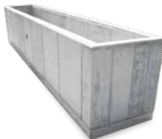
KRASO® Pumpensumpf - Beton - Sonder Innenmaße ca. 100 x 750 x 140 cm, aus WU-Beton, mit 20 cm starker, stahlfaserbewehrter Wand- und Bodenplatte (20 kg/per cbm) und 1 x Rohranschluss DN 110, ohne Anschlussbewehrung, ohne Fugenband Gesamtgewicht: ca. 17,5 t
