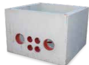
KRASO® Pumpensumpf - Beton - Sonder Innenmaße ca. 100 x 100 x 80 cm, aus WU-Beton, mit 12 cm starker, stahlfaserbewehrter Wand- und Bodenplatte (20 kg/ per cbm). Anschlüsse: 2 x DN 200, 4 x DN 110, 1 x DN 110 im Boden, Gesamtgewicht: ca. 1,5 t
