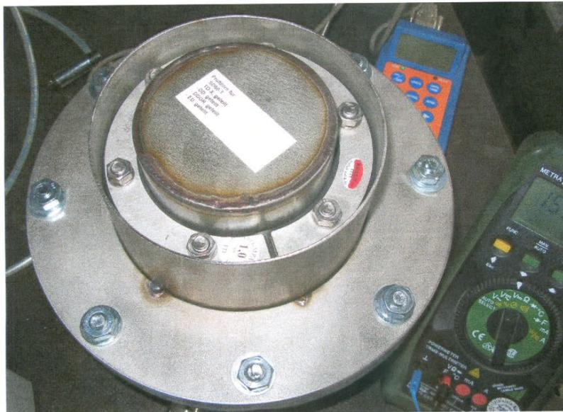
Abbildung 5: Prüfung des Dichtungssatzes „Kraso ED, geteilt“ (#6) mit Prüfbehälter des Auftraggebers, rechts oben: Messanzeige für Drehmomentaufnahme, rechts unten Handmultimeter für Druckanzeige
