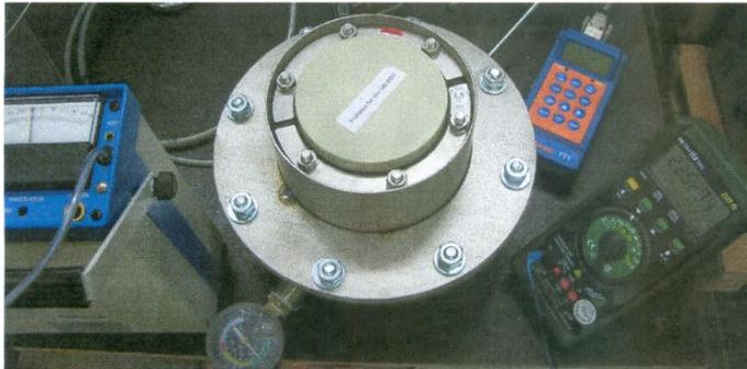
Abbildung 1: Prüfung des Dichtungssatzes Kraso Uni 150 DD/T (#1) mit Prüfbehälter des Auftraggebers (Mitte), links Lecksucher, rechts oben: Messanzeige für Drehmomentaufnehmer, rechts unten Handmultimeter für Druckanzeige
