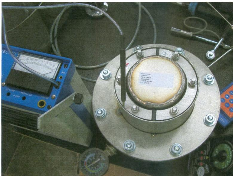
Abbildung 3: Demonstration der Prüfung eines Dichtungssatzes „Kraso SD 60, geteilt“ bzw. „Kraso SD 60, TD-X geteilt“ mit Lecksuchsonde (Mitte) entlang möglicher Leckagestellen (Zeigerausschlag zeigte bei diesem Vortest Wasserstoff und damit eine Leckage an)
